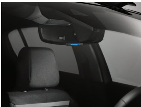
LED kontrolka signalizuje jízdu v elektrickém režimu
