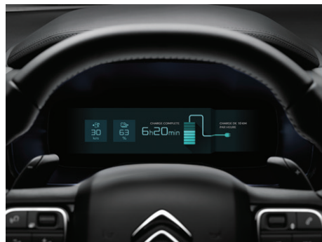
Digitální přístrojový 12,3", displej se zobrazením hybridního režimu
